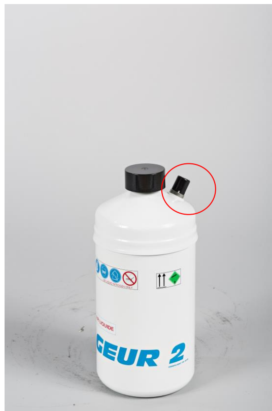
Фигура 4-1 : Пример за мястото на клапана на помпата на VOYAGEUR 2
