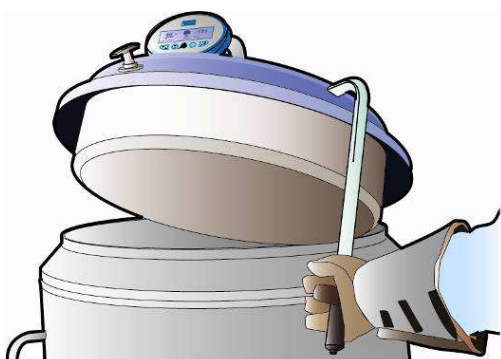
Ilustracja 8-10: Otwieranie lub zamykanie korka skompensowanego - ESPACE 331 i 661.
