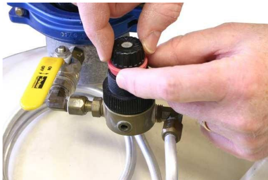
Slika 9-2: rdeč zaporni obroč na regulatorju.
