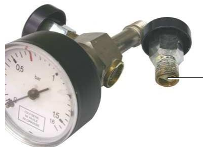
Slika 9-1: izpihovanje sedišča ventila.
