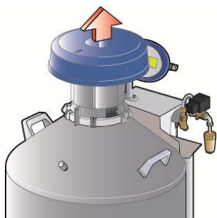
8-8. ábra: a dugó kinyitása vagy bezárása
