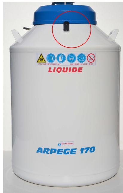
4-1. ábra: Példa az ARPEGE 170 pumpáló szelep elhelyezésére
