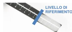
Figura 12 - Lettura del livello sull'indicatore
