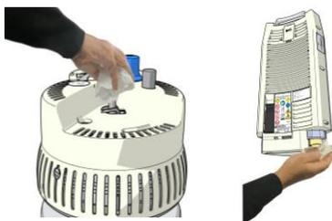
Elimine qualquer vestígio de humidade no terminal de enchimento da reserva e do FREELOX PORTABLE utilizando um **pano de algodão limpo que não largue pelo** (a humidade provoca a formação de gelo no terminal e pode resultar numa fuga de oxigénio).
