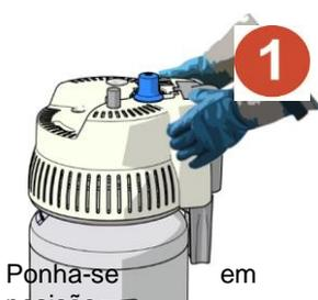
1 Uma vez removida a tampa de proteção do terminal de enchimento da reserva, posicione-se à frente desta, ou seja, diante do coletor de condensados de forma a proteger-se do fluxo de oxigénio frio. Tal evitará igualmente que o oxigénio libertado pelas aberturas da reserva aquando do enchimento se acumule na roupa e apresente um risco de eventual inflamação posterior.
