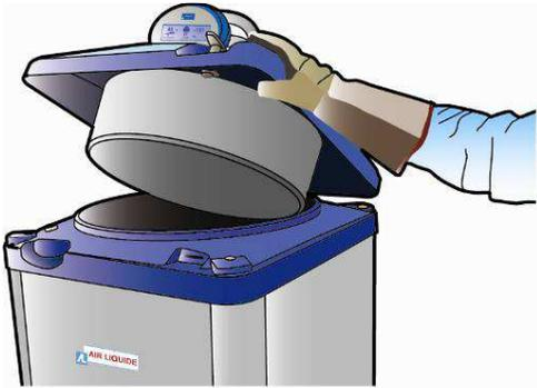
Abbildung 8-9: Öffnen oder Schließen des gedämpften Verschlusses - ESPACE 151
