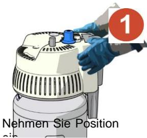
**1** Den Schutzstopfen des Tankstutzens entfernen, sich vor den Tank, d. h. gegenüber dem Kondensatbehälter aufstellen, um sich vor dem austretenden kalten Sauerstoff zu schützen. Damit wird auch vermieden, dass der durch die Behälteröffnungen beim Befüllen freigesetzte Sauerstoff sich in der Kleidung anreichern kann und sich ggf. zu einem späteren Zeitpunkt entzündet.
