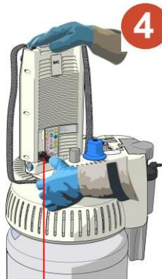
**4** Hebel des Entlüftungsventils
