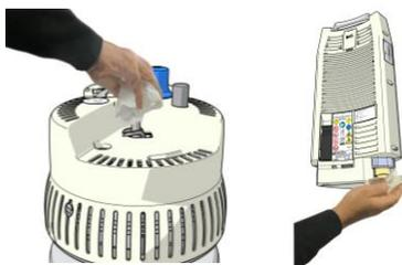
Alle Spuren von Feuchtigkeit an dem Füllstutzen des Tanks und des FREELOX PORTABLE mit einem **nicht fuselnden, sauberen Baumwolltuch** abwischen. (Feuchtigkeit führt zu Reif- oder Eisbildung am Stutzen und kann zu Sauerstoffverlust führen). Den Wahlschalter für die Sauerstoffmenge am FREELOX PORTABLE auf **0** stellen.
