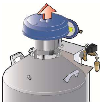
Фигура 8-1: отваряне и затваряне на запушалката
