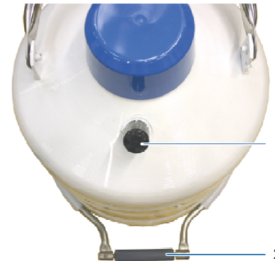
Figure 7-7 : poignée verseuse, étape 2.
