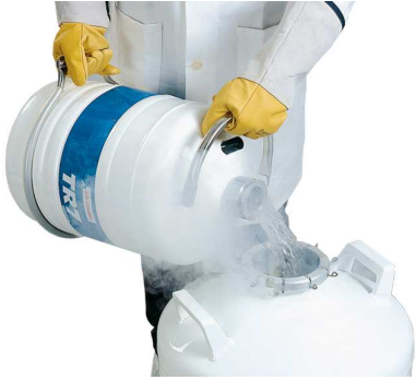
Figure 8-1 : remplissage à partir d'un récipient TR ; étape 1.
