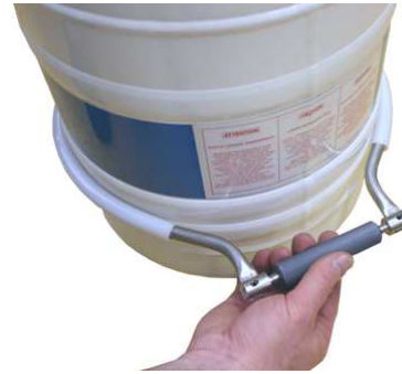
Figure 7-6 : poignée verseuse, étape 1.
