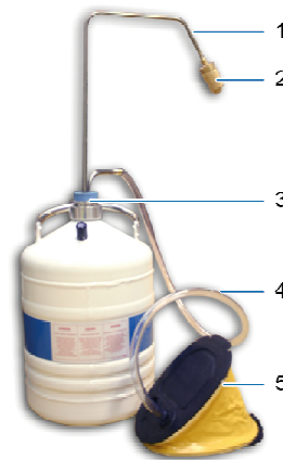
Figure 5-2 : vue du système de soutirage.
