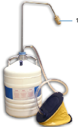
Figure 8-7 : soutirage avec la pompe à pied.
