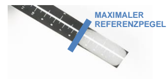
Abbildung 12 - Ablesen des Füllstands auf der Anzeige
