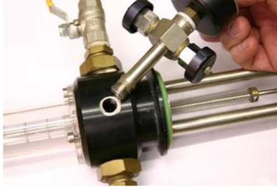
3. Aplicar a fita PTFE ou massa estanque (silicone, etc.) sobre os fios da peça de reposição, tendo cuidado para não obstruir os orifícios.
