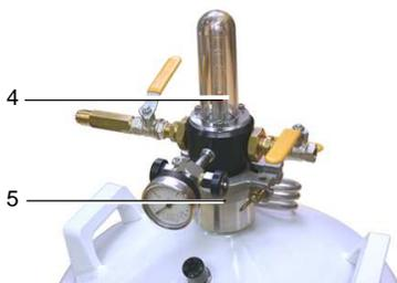
3. Extrair a cabeça de controlo (ref. 4) do reservatório levantando-o e depositando-o sobre um apoio adaptado.
