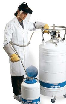
4. Mantendo o tubo flexível, abrir **progressivamente** a válvula de extração (ref. 1) para iniciar a extração controlando o débito.
