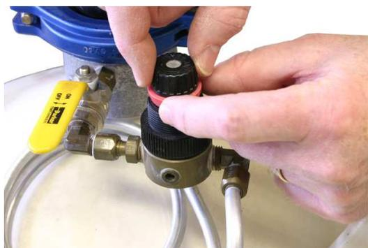
Figura 1-2 : Anel de bloqueio vermelho do regulador.
