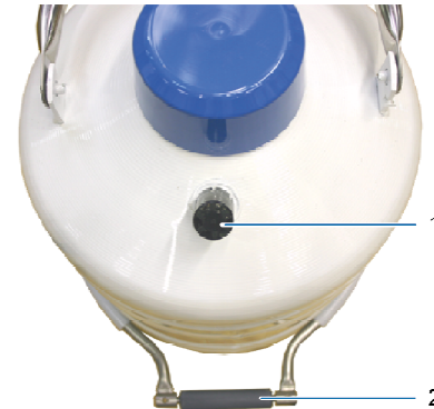
Figura 7-7 : empuñadura de vertido, etapa 2.
