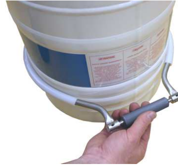
Figura 7-6 : empuñadura de vertido, etapa 1.
