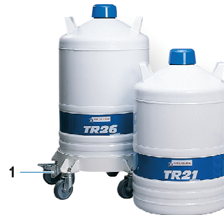
Figura 5-4 : recipientes con y sin la base con ruedas.
