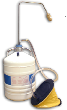
Figura 8-7 : vaciado con bomba de pie.
