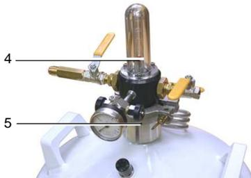
3. Füllkopf (4) nach oben aus dem Behälter herausziehen und auf einer geeigneten Unterlage ablegen.
