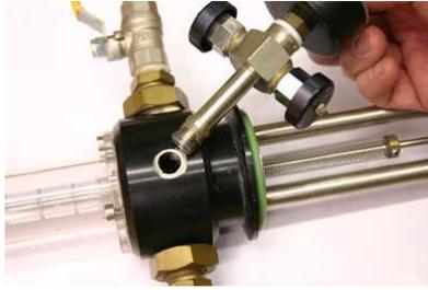
3. Teflonband oder Dichtpaste (Silikon usw.) auf das Gewinde des Neuteils aufbringen und dabei darauf achten, keine Öffnungen zu verschließen.
