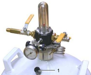
8. Befüllventil (1) schließen. Schlauch (4) vom Behälter und dem Ausgangsventil der Leitung (oder des Nachfülltanks) abziehen. Lüftungsventil (2) schließen, sobald kein Gas mehr austritt.
