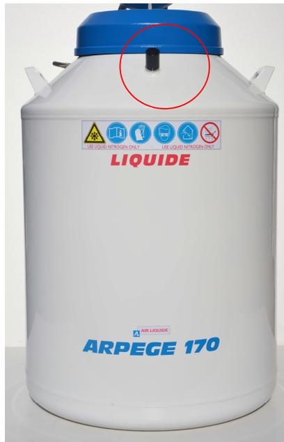
Figura 4-1: Ejemplo de ubicación de la válvula de bombeo ARPEGE 170
