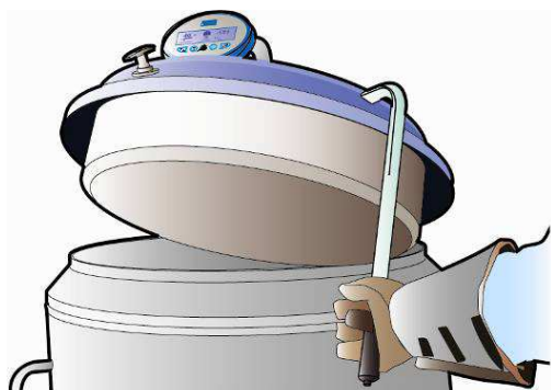
Paveikslėlis 8-10: Dangtelio su kompensatoriumi atidarymas ir uždarymas – ESPACE 331 ir 661.
