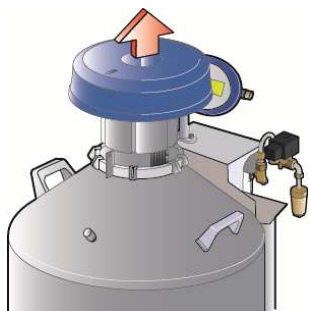
Rysunek 8-1: otwarcie lub zamknięcie korka GT40
