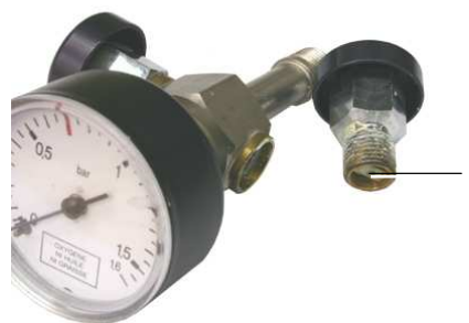
Figura 9-1 : soplado de la base de la válvula.
