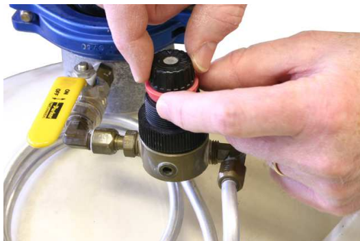
Figura 9-2 : anillo de bloqueo rojo del regulador.
