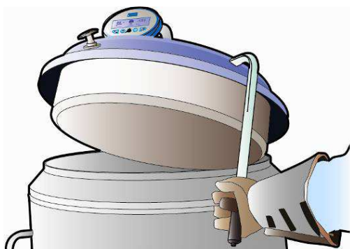
Kuva 8-10: Tuetun korkin avaaminen ja sulkeminen – SPACE 331 ja 661.
