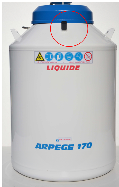
Obrázok 4-1: Príklad umiestnenia čerpaceho ventilu ARPEGE 170
