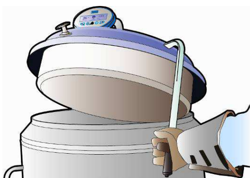
Figura 8-10: abertura ou fecho da tampa compensada - ESPACE 331 e 661
