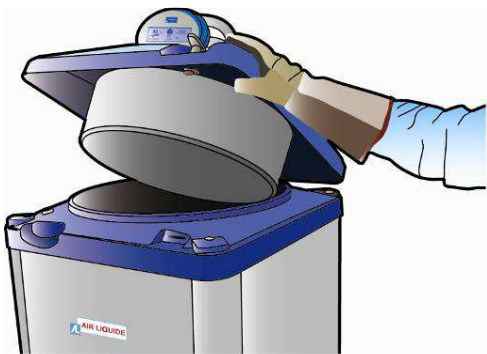
Figura 8-9: abertura ou fecho da tampa compensada - ESPACE 151
