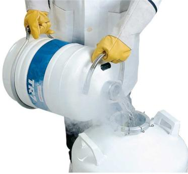
3. Die Menge an nachgefülltem Flüssigstickstoff kann nach dem Gewicht kontrolliert werden: bei Atmosphärendruck wiegt 1 l N<sub>2</sub> (flüssig) rund 0,808 kg. Zum Gewicht vgl. Tabelle in Abschn10.1, Seite 30.
