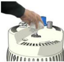
Alle Spuren von Feuchtigkeit an dem Füllstutzen des FREELOX RESERVE und Mobilteils mit einem **nicht fuselnden, sauberen Baumwolltuch** abwischen. (Feuchtigkeit führt zu Eisbildung am Stutzen und kann zu Sauerstoffverlust führen).
