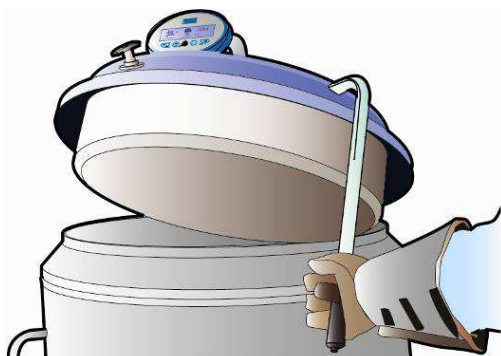
Figura 8-10: Apertura o cierre del tapón compensado – ESPACE 331 y 661
