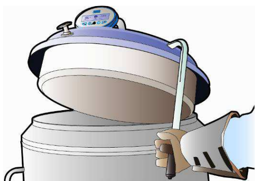
Joonis 8-10: Kompensaatoriga korgi avamine või sulgemine – ESPACE 331 ja 661
