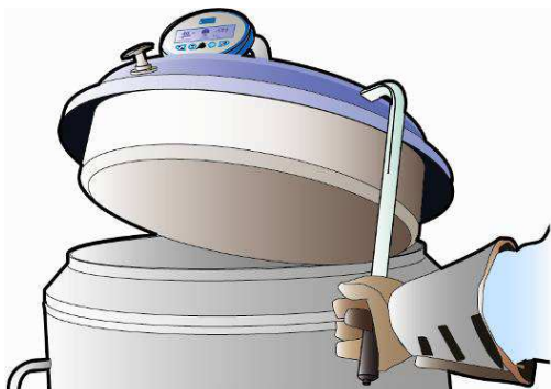
Фигура 8-10 : Отваряне или затваряне на запушалка с компенсирателен механизъм – ESPACE 331 и 661.
