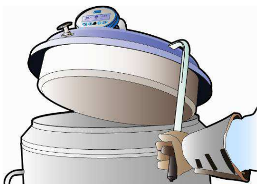
Figur 8-10: Åbning eller lukning af en kompenseret prop – ESPACE 331 og 661.
