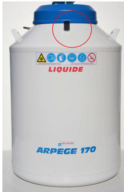
Kuva 4-1: Esimerkki ARPEGE 170 -laitteen pumppausventtiilin sijainnista
