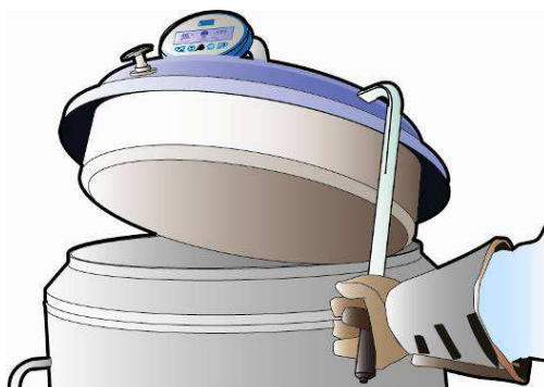
Figura 8-10: Deschiderea sau închiderea dopului compensat - ESPACE 331 și 661.
