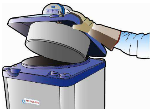
Figura 8-9: Deschiderea sau închiderea dopului compensat - ESPACE 151
