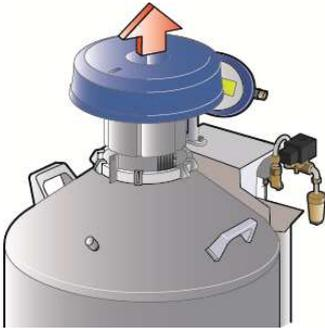
Figure 8-1 : ouverture ou fermeture du bouchon GT40
