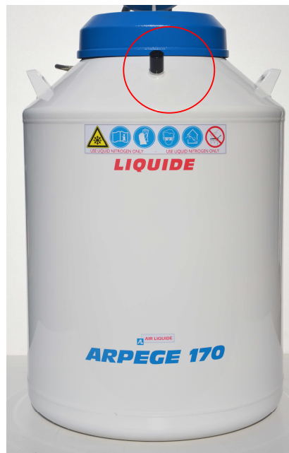
Abbildung4-1: Beispiel für die Lage des ARPEGE 170-Pumpventils
