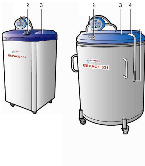
3-2. ábra: Az ESPACE 151 (baloldalon) és 331 vagy 661 (jobboldalon) típusú kriogén berendezések általános kinézete.
