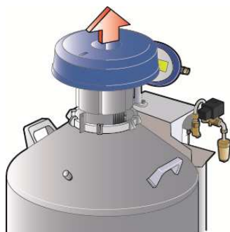
Obrázek 8-1 : Otevírání a zavírání víka GT40
