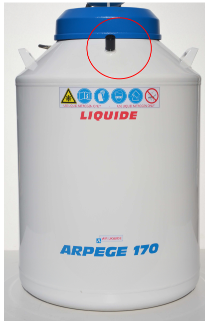
Paveikslėlis 4-1: Pumpavimo vožtuvo veikimo pavyzdys - ARPEGE 170
